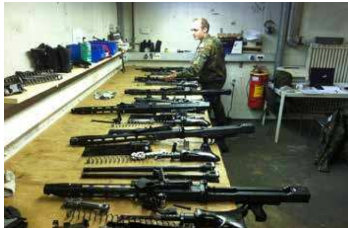
Geräteprüfer SK (FT Waffe) beim Durchführen der TMP am MG 3
